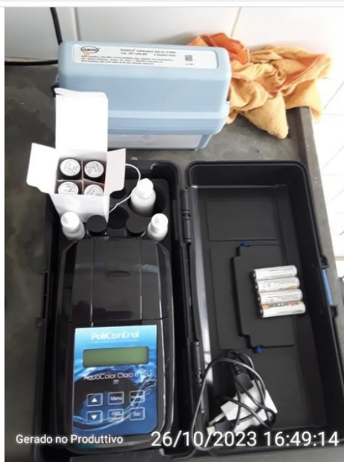
Equipamentos reserva - Cloro e pH
