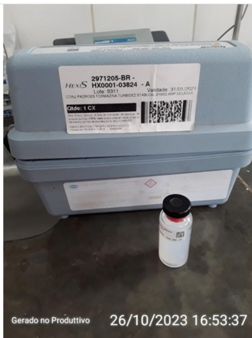
Calibrador Vencido - Turbidímetro
