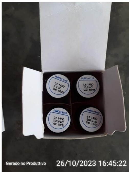
Calibradores vencidos - Colorímetro
