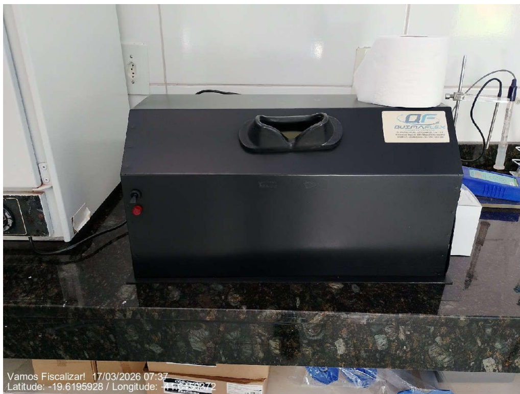
Câmara de UV para análise de E. coli
