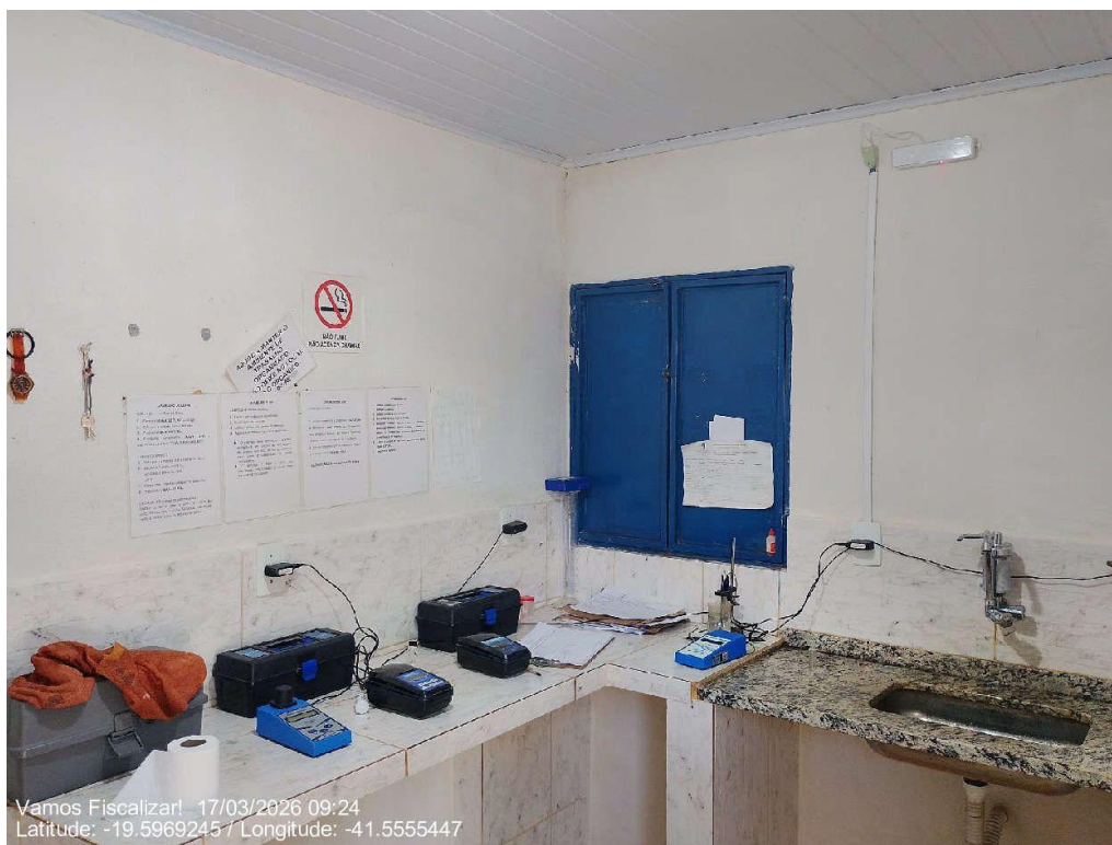
Ausência de chuveiros de emergência e/ou lava olhos
