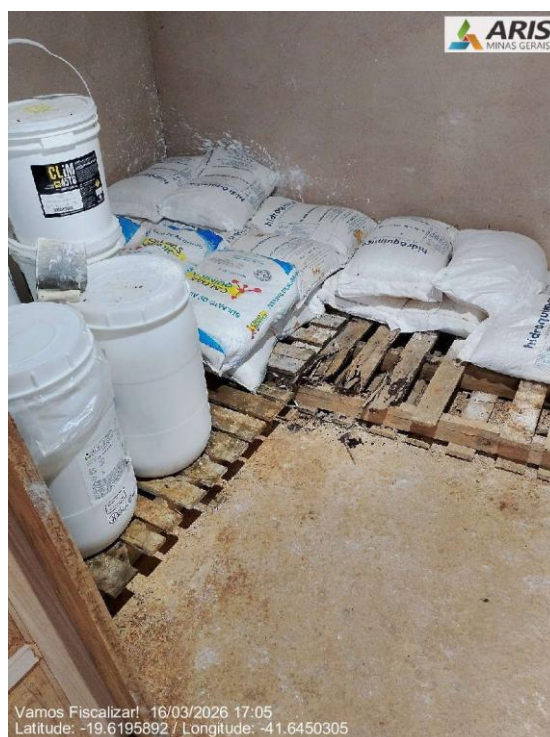
Paletes apresentam infestação por cupins e encontram-se danificados
