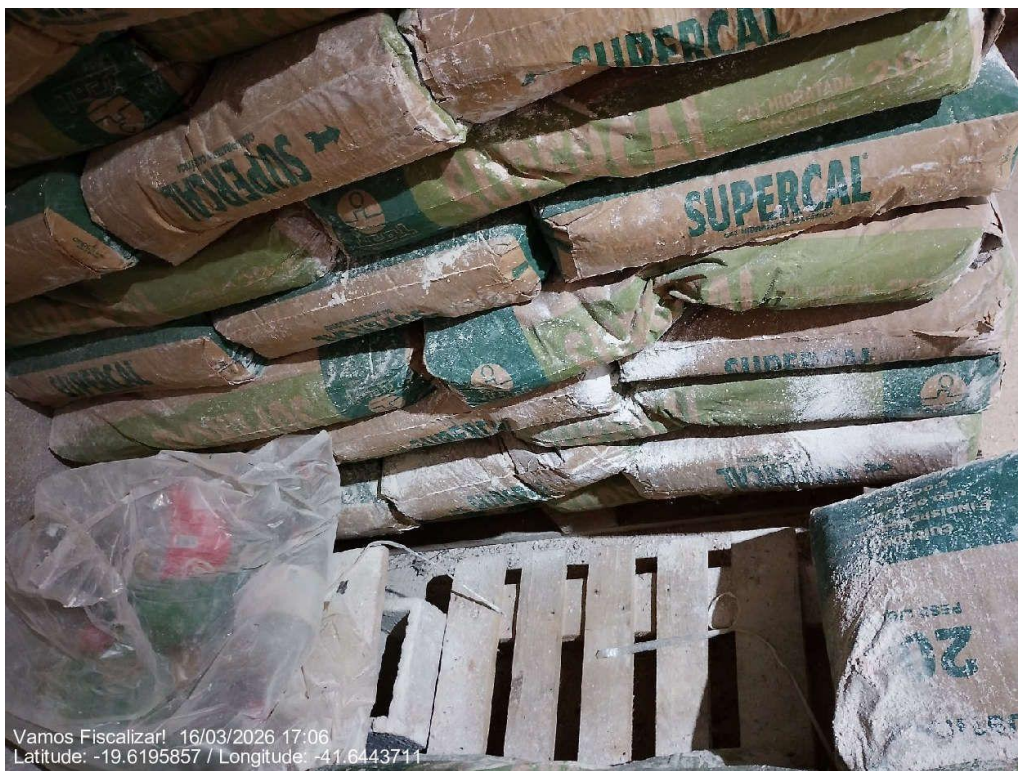
Produtos estocados em paletes, mas com vazamento de produto
