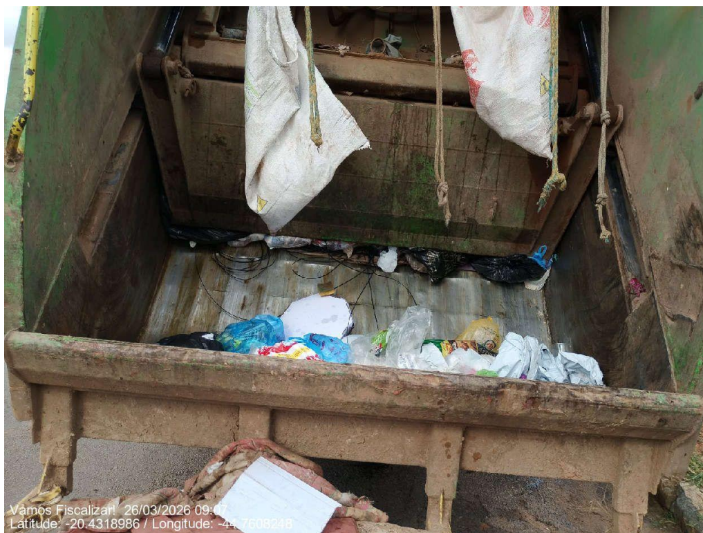
Escorrimento do chorume dentro do compactador.
