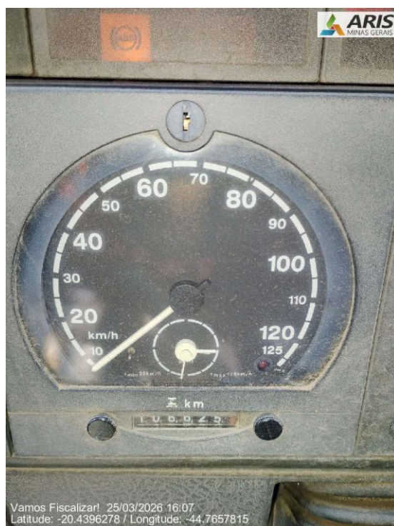
Ausência de tacógrafo.
