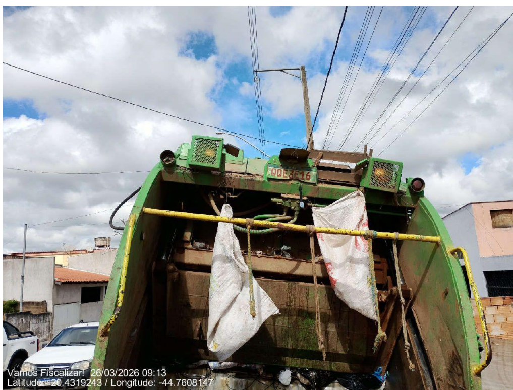
Iluminação vermelha de ré. A de ré esquerda não acende.
