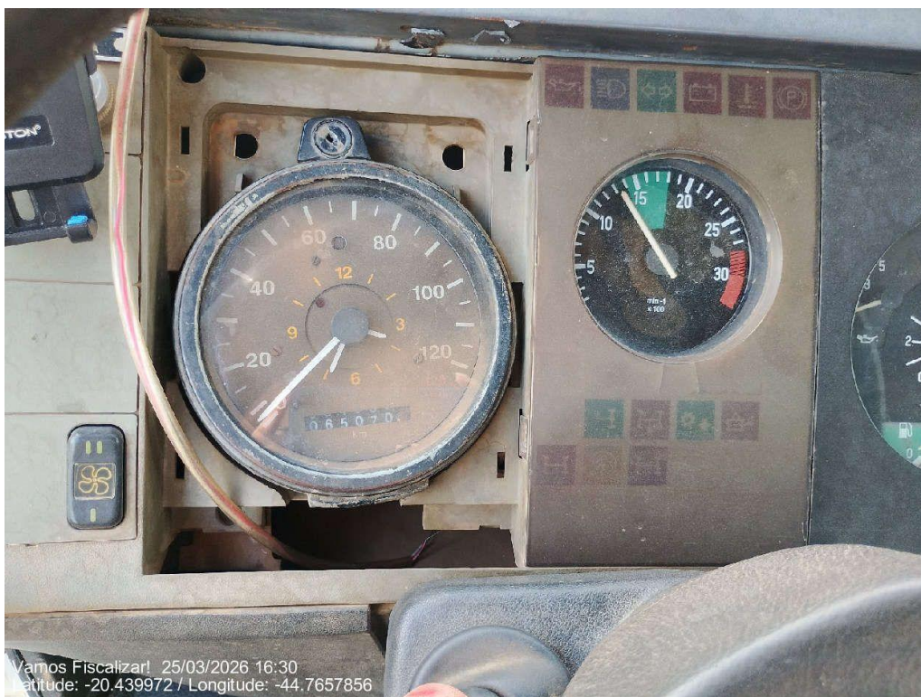
Tacógrafo sem funcionamento.
