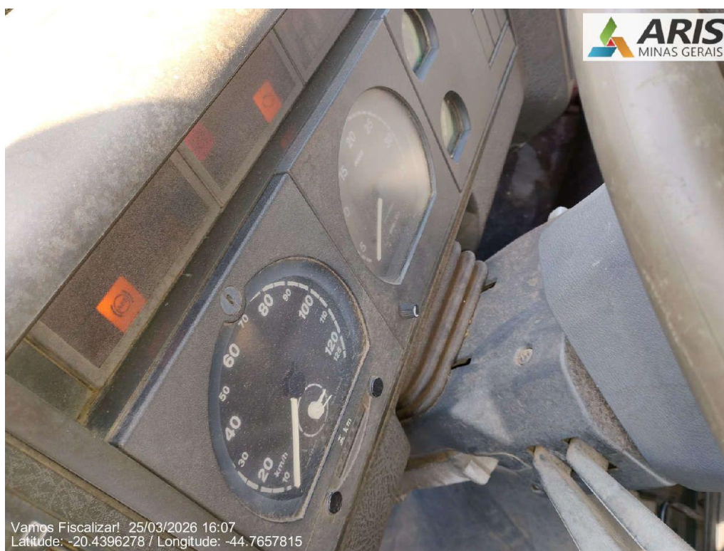
Ausência de tacógrafo.
