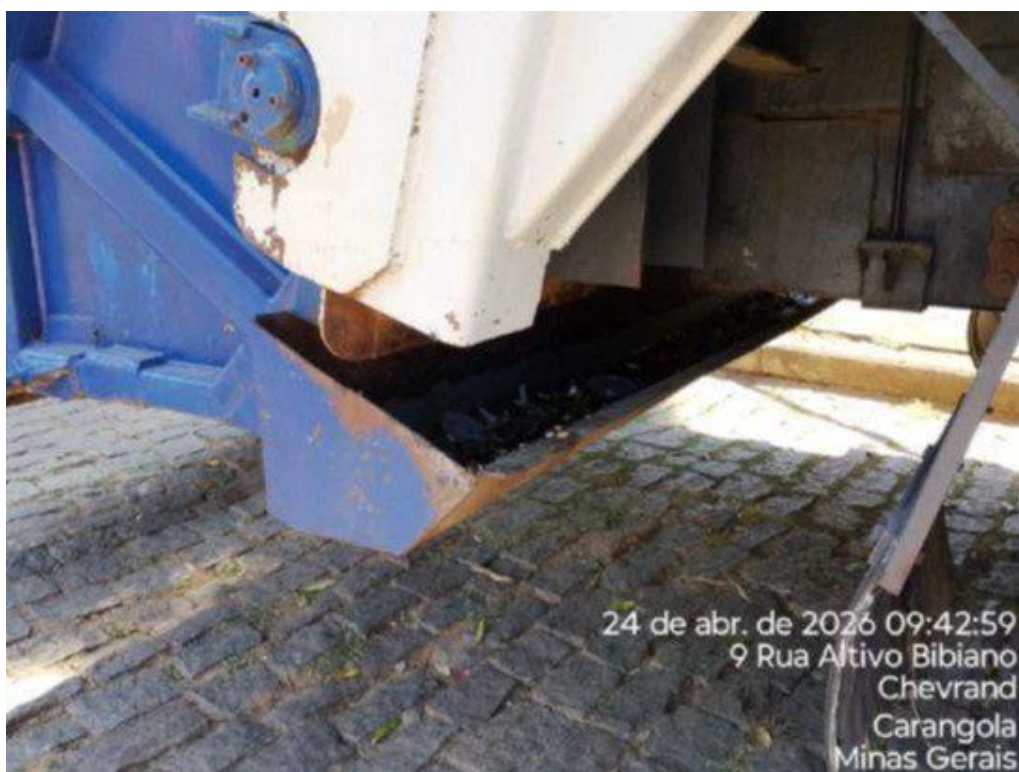
Caminhão possui canaleta de chorume.
