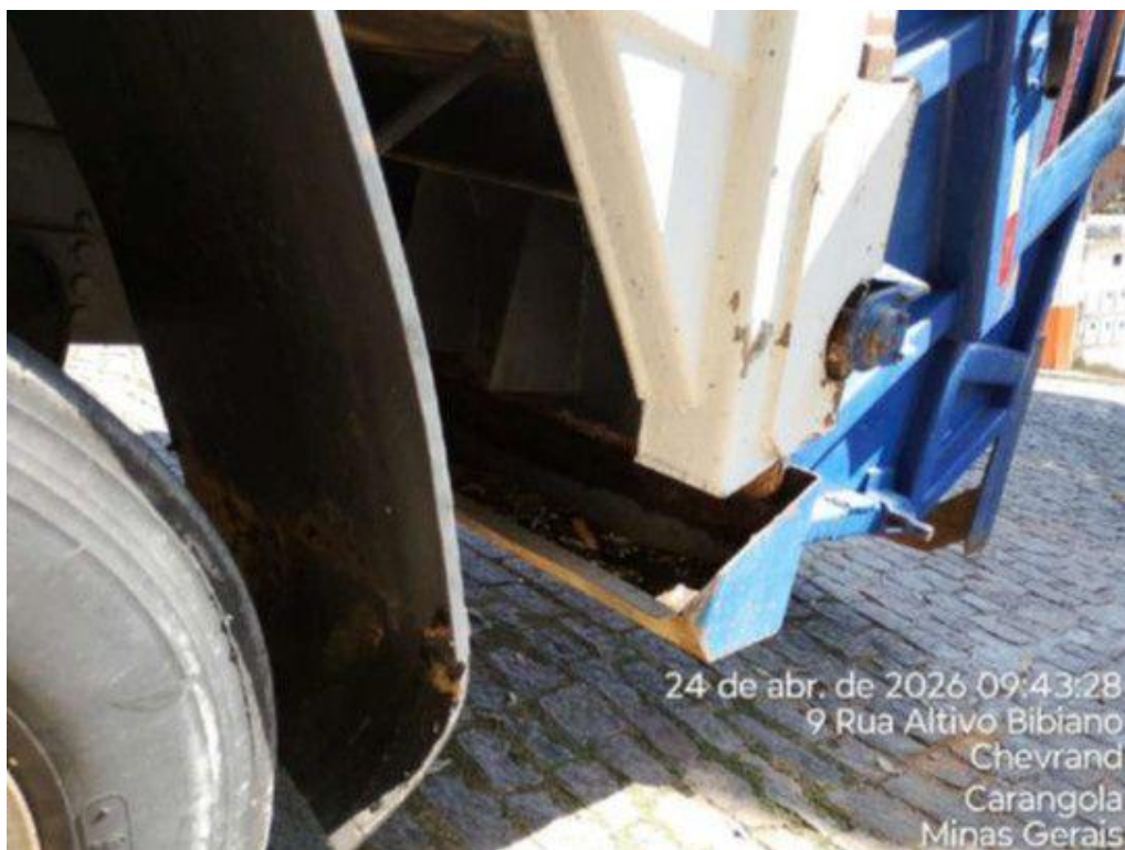
Caminhão possui canaleta de chorume.
