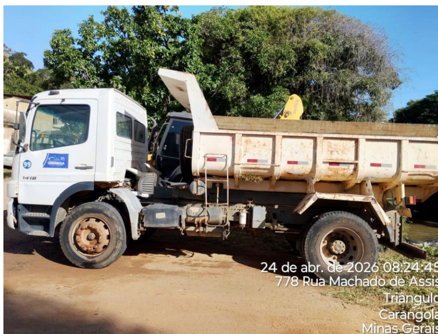
Falta lona ou outro dispositivo que impeça a ação de intempéries.
