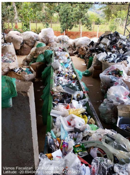
Esteira para triagem dos materiais quebrada, funcionando como mesa de triagem
