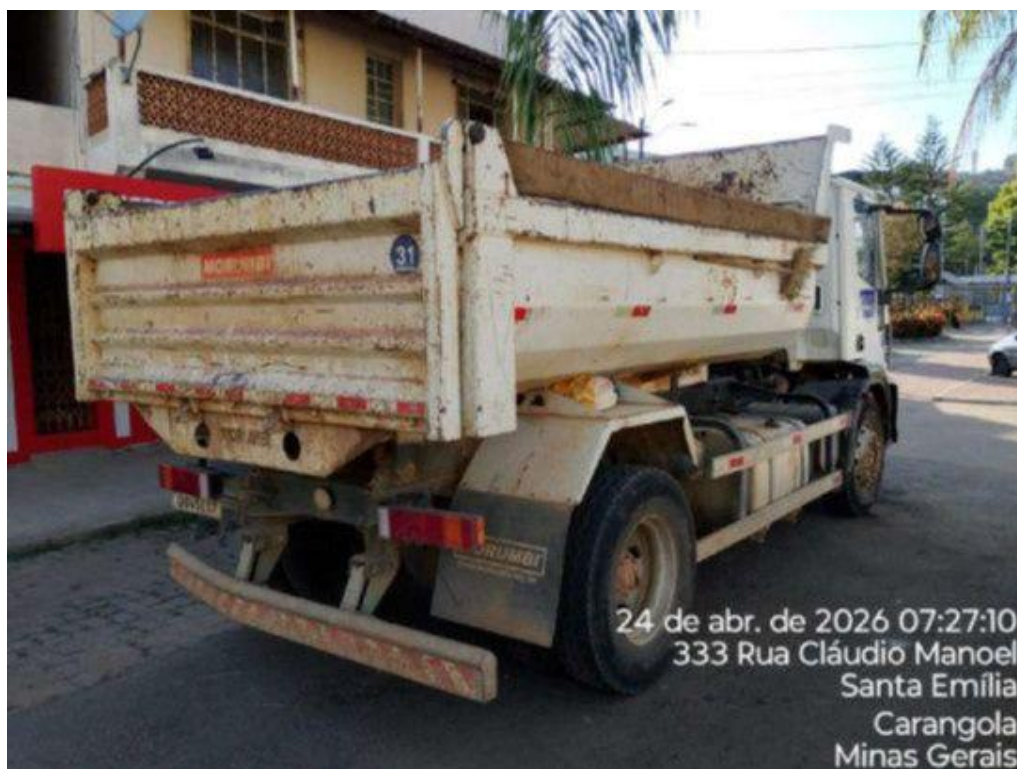
Ausência de lona.
