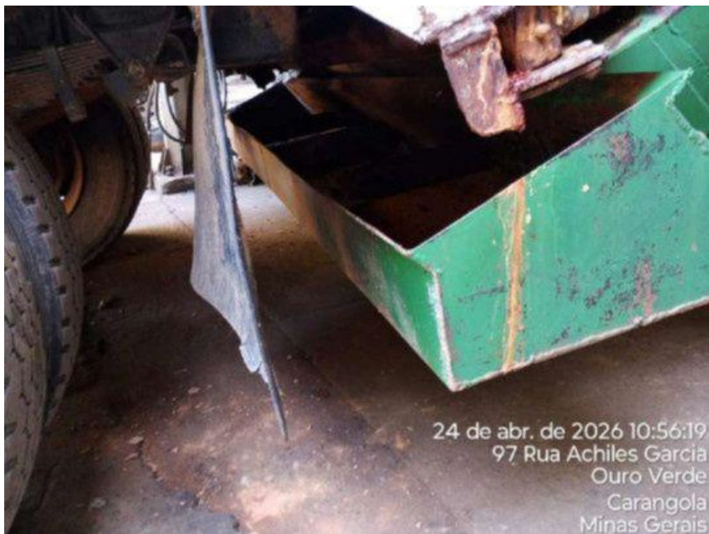
Canaleta de chorume.
