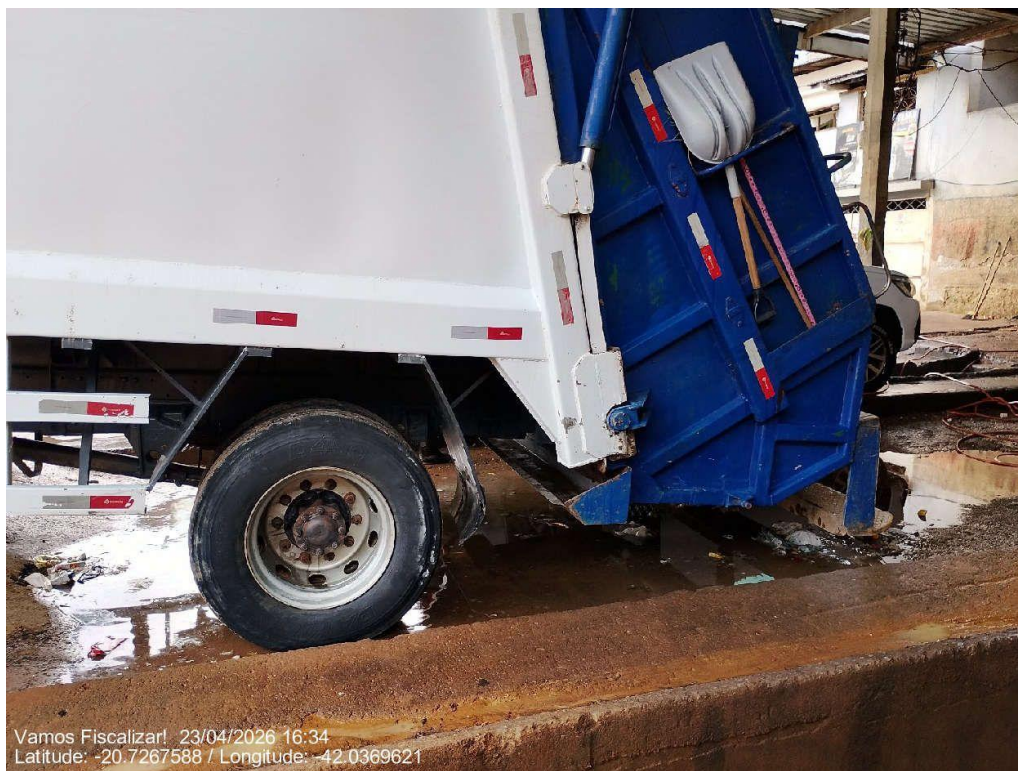
Descarte de chorume no momento da lavagem dos caminhões compactadores.
