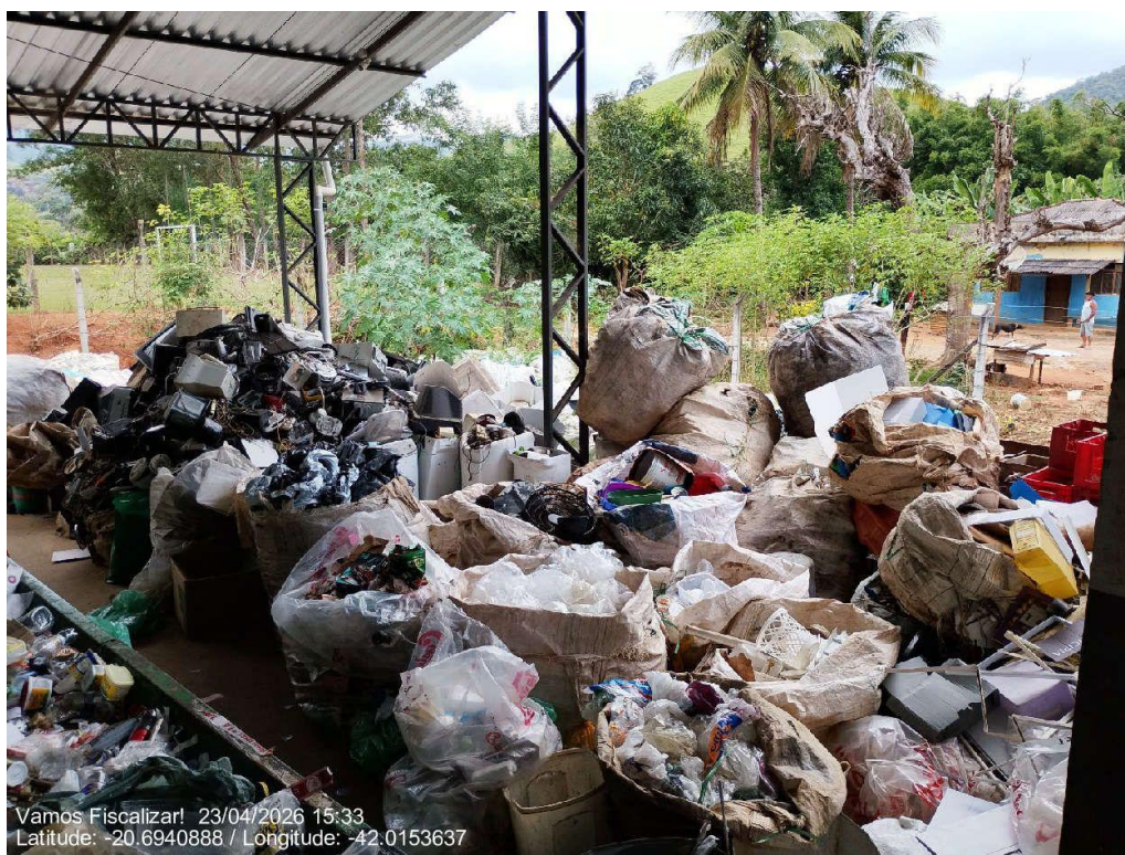
Ausência de baias na área de triagem
