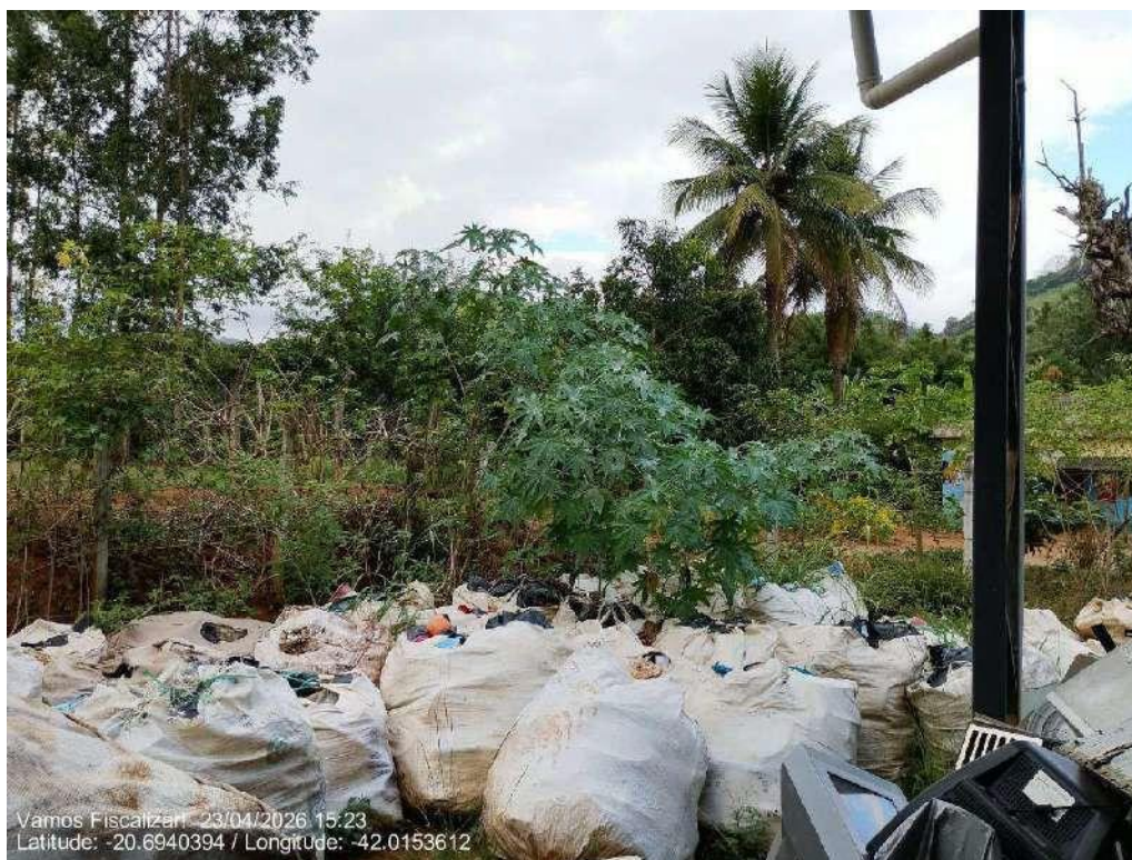
Bags com materiais separados dispostos em área sem cobertura e sem piso impermeável.
