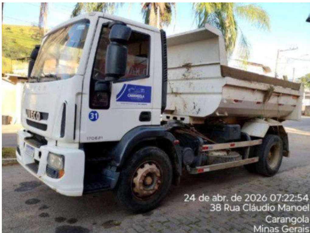
Ausência de lona.
