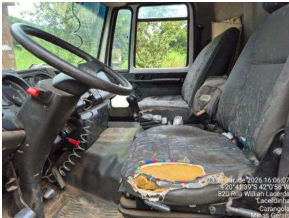
Estofado do caminhão encontrava-se rasgado.
