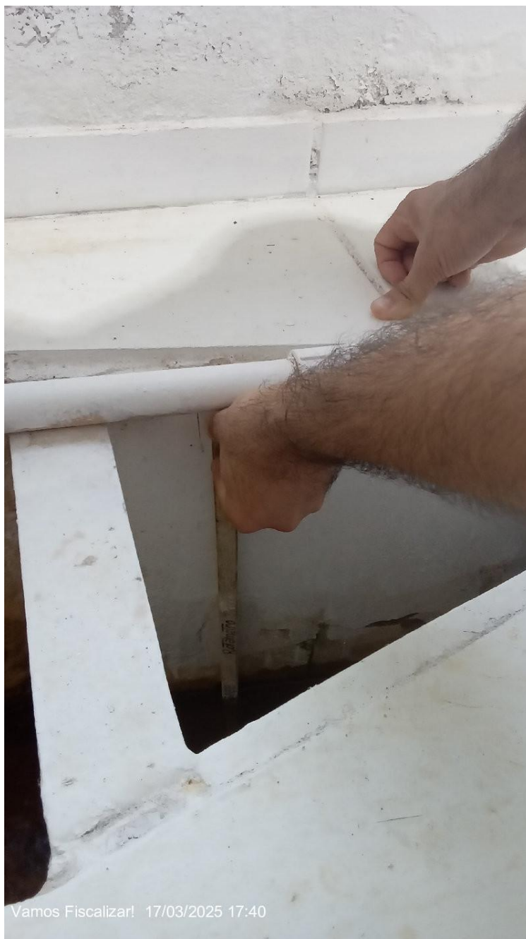
Régua para aferir a vazão de entrada.
