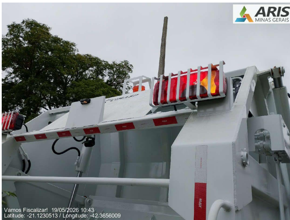
Iluminação traseira em funcionamento. Presença de giroflex.
