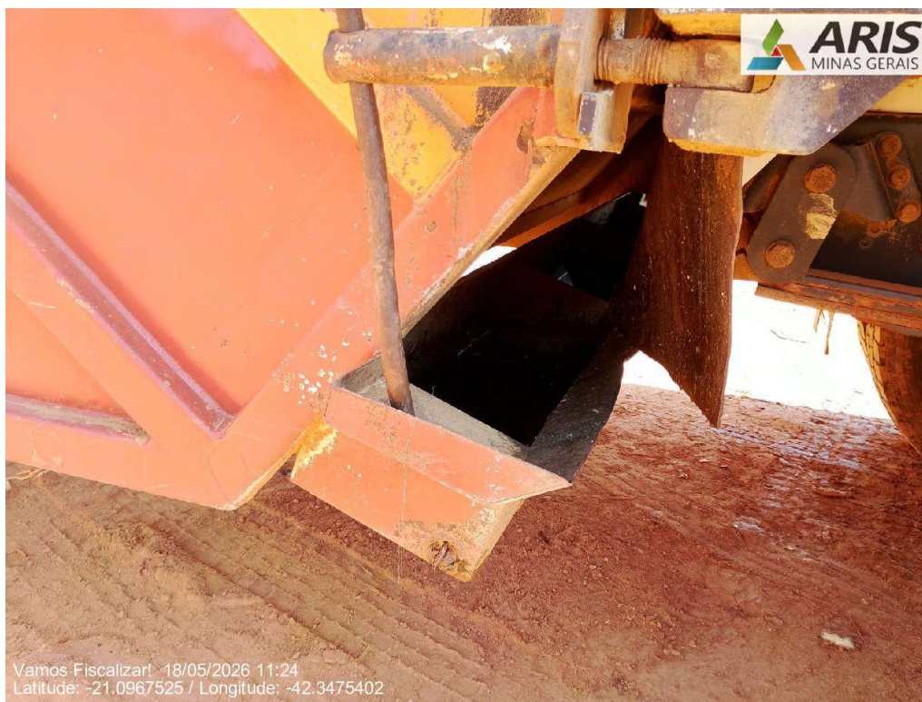
Canaleta de chorume.
