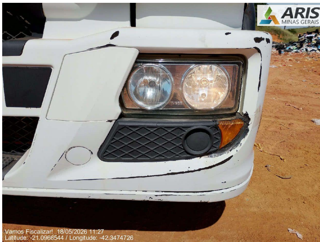
Seta indicadora de direção do veículo, lado esquerdo, com defeito.
