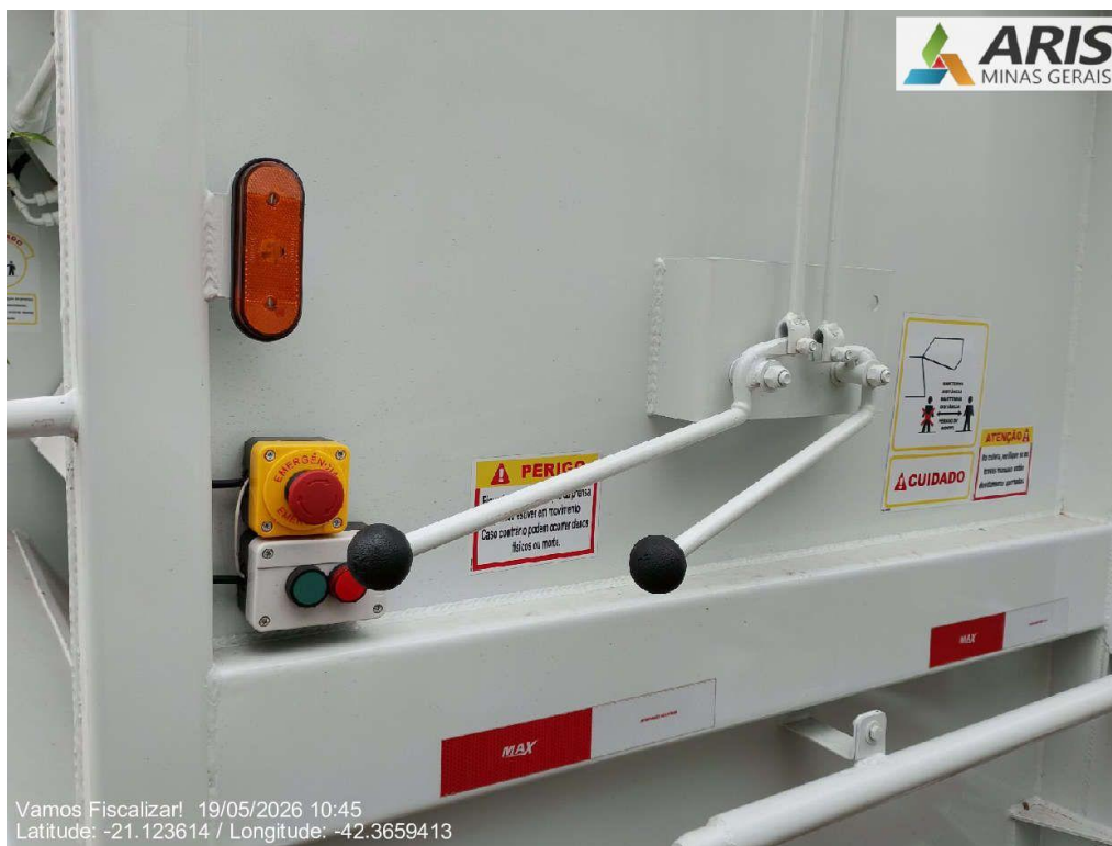
Veículo com dispositivo de parada de emergência.
