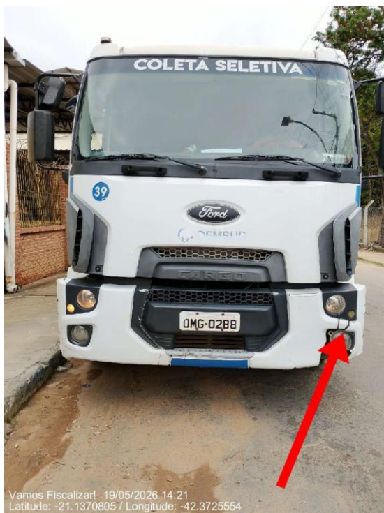
Seta indicadora de direção do veículo (lado esquerdo) inoperante.
