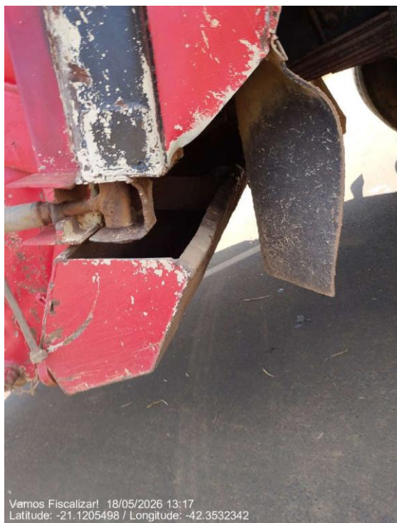
Vazamento na calha de chorume.
