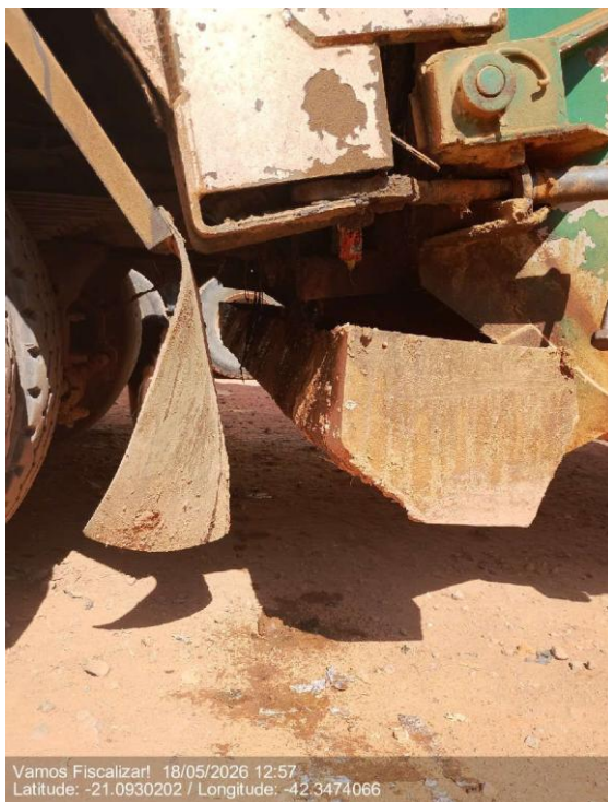
Canaleta de chorume com vazamento.
