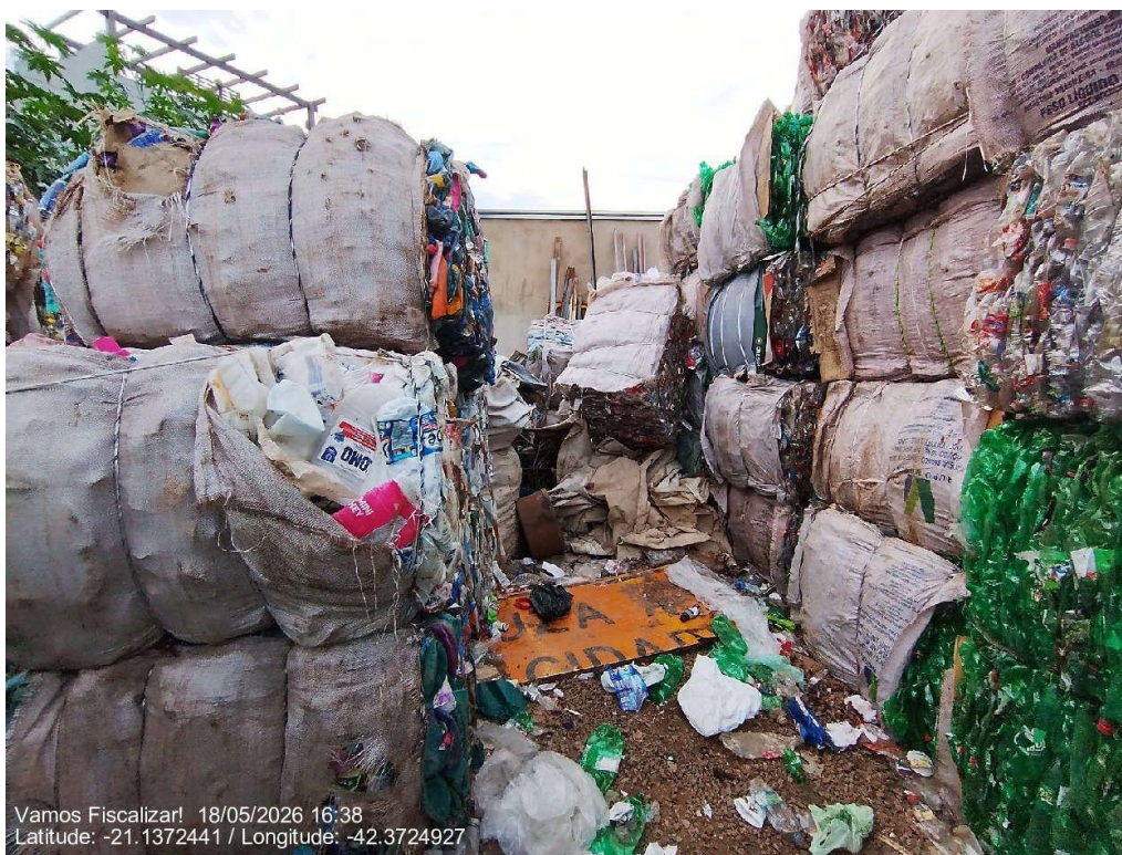
Fardos de resíduos recicláveis armazenados diretamente sobre o solo e sem cobertura.
