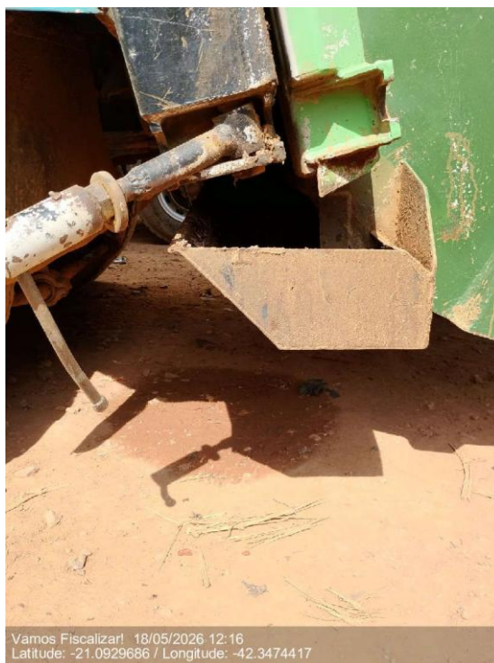
Canaleta de chorume.
