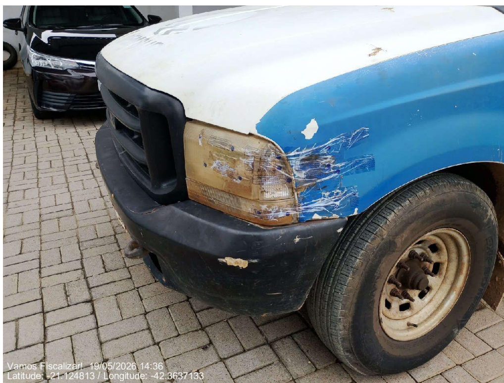
Farol com reparos provisórios.
