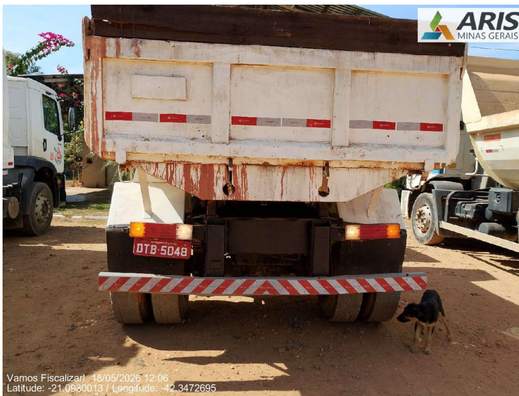
Iluminação traseira e sinalização sonora em funcionamento.
