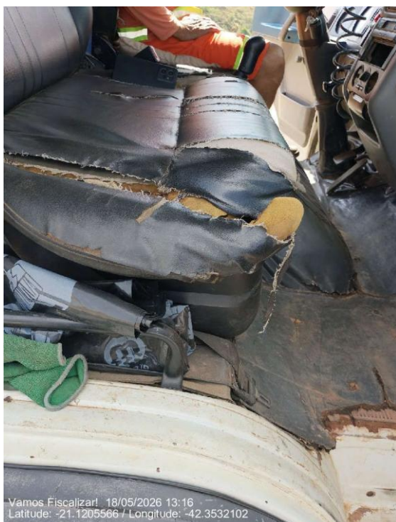
Banco do veículo está danificado.
