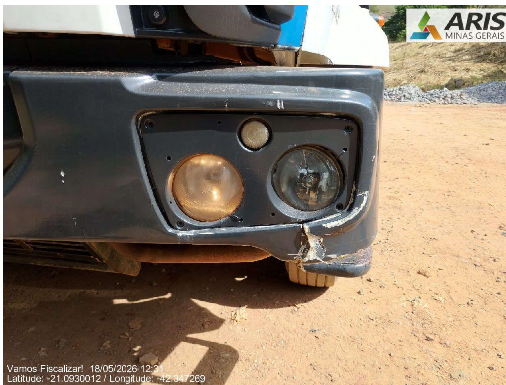
Seta indicadora de direção do veículo (lado esquerdo) inoperante.
