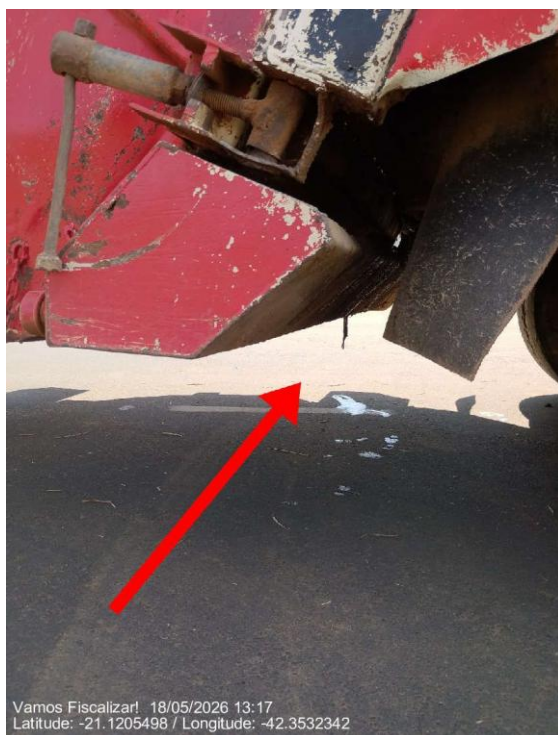
Vazamento na calha de chorume.
