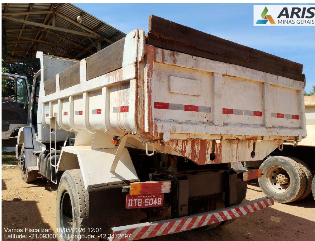
Traseira do caminhão basculante sem calha coletora de chorume.
