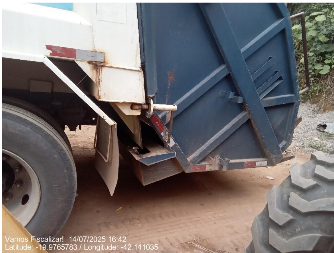
Calha de drenagem de chorume.
