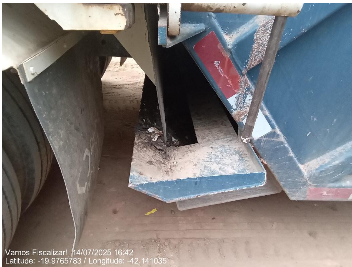
Calha de drenagem de chorume.
