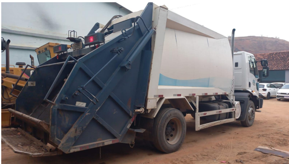
Sistema de compactação do caminhão próprio.
