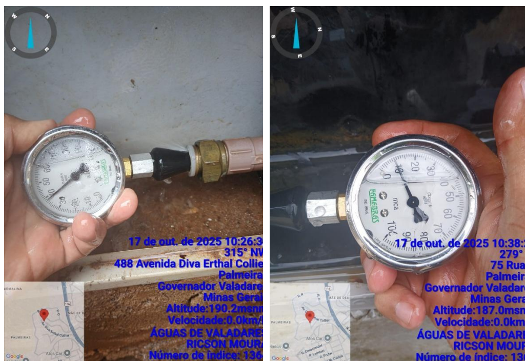
Figura 7: Aferição de pressão nas ruas C e Av. Diva Erthal no Palmeiras.
