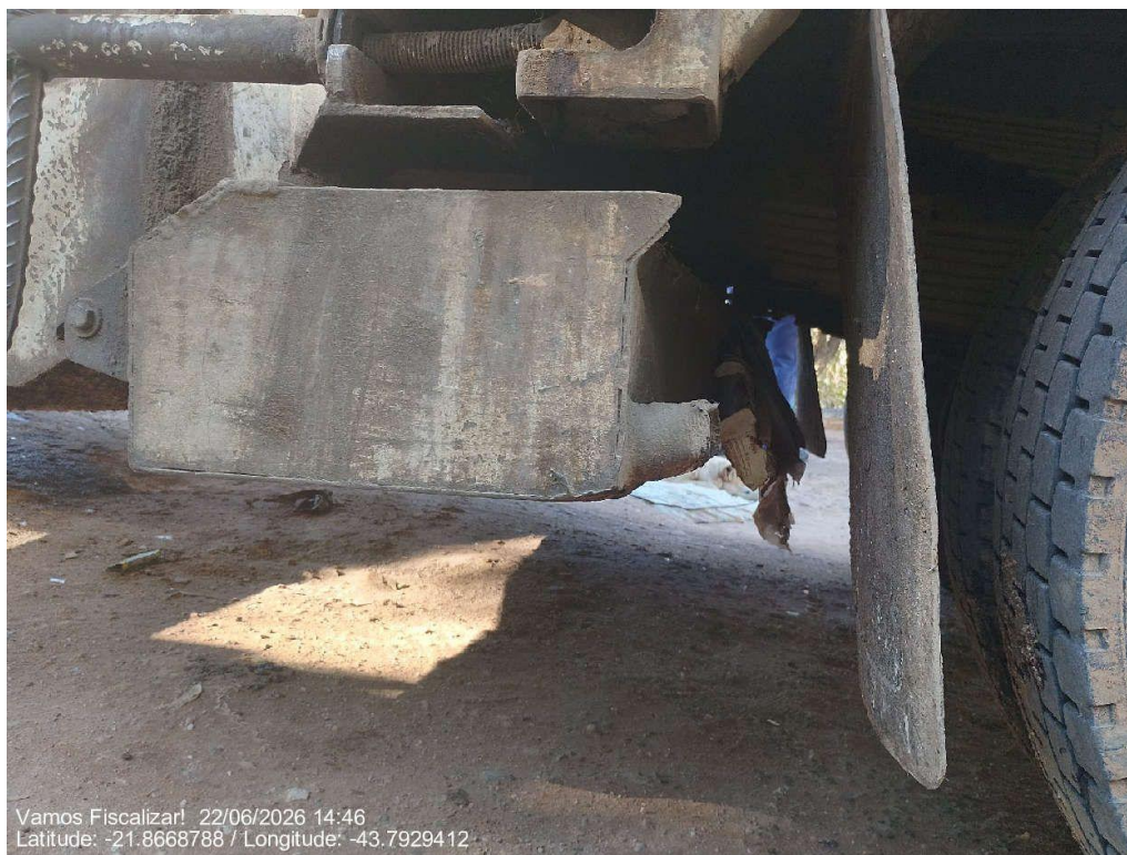
Compartimento de coleta de chorume
