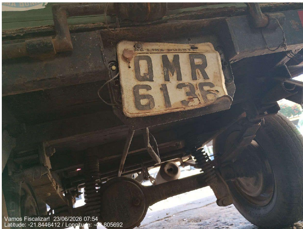
Fundo da carroceria em bom estado de conservação
