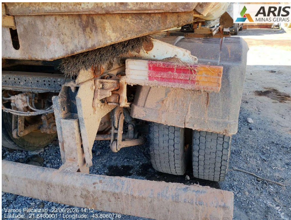
Ausência de inumação de ré e pista alerta.
