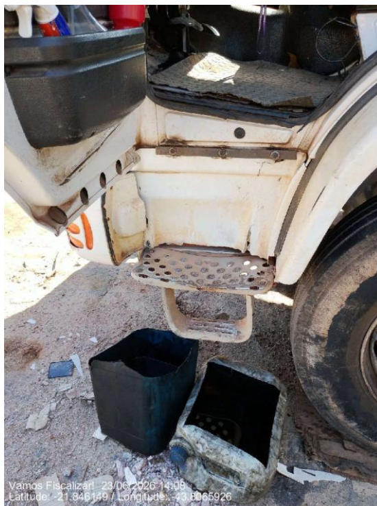
Degraus de acesso a cabine precários
