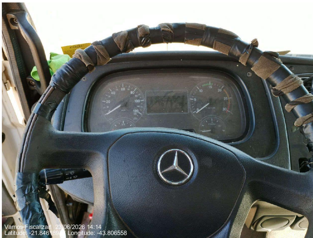
Volante desgastado e com remendas
