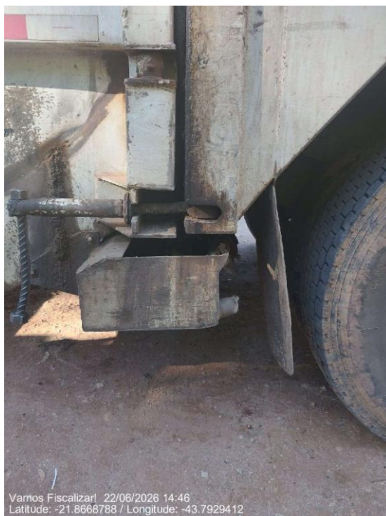
Compartimento de coleta de chorume
