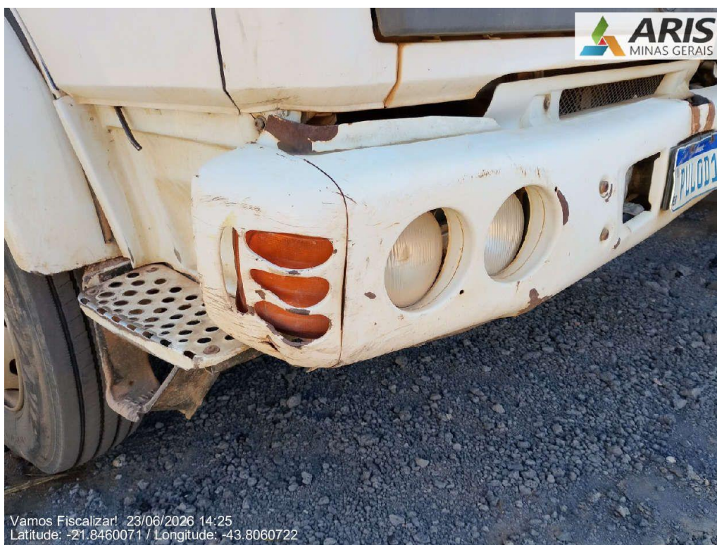
Ausência de pista alerta.
