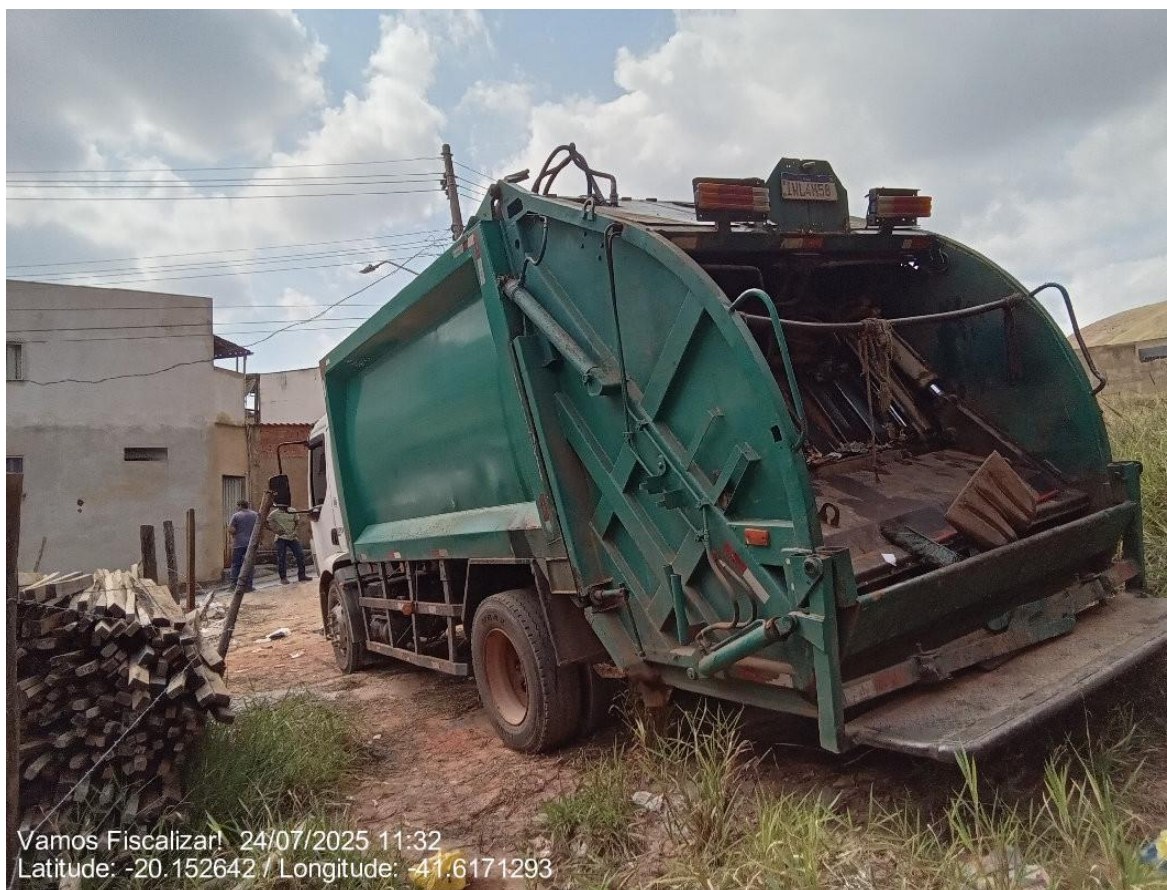
Sistema de compactação do caminhão terceirizado.
