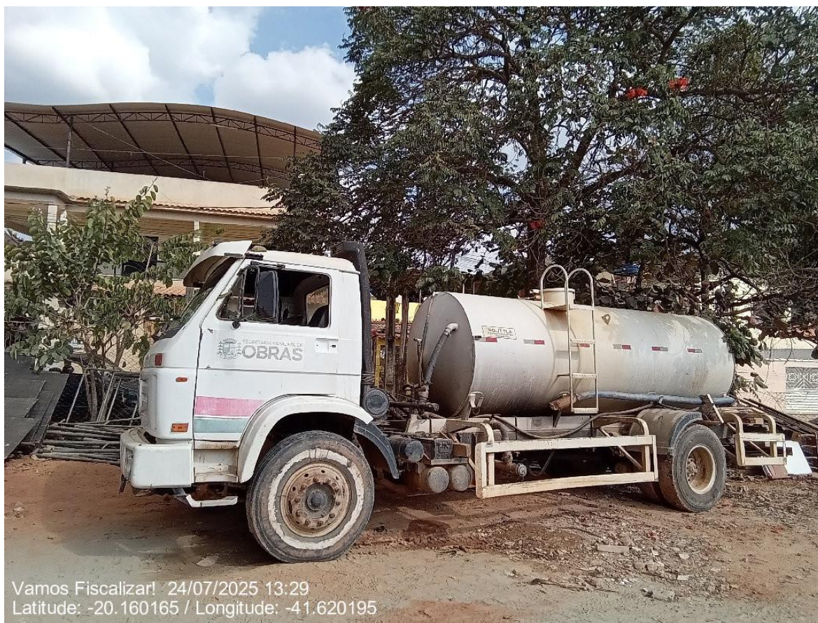
Caminhão pipa disponibilizado pela Secretaria de Obras para lavagem de vias em casos de derramamento de chorume.
