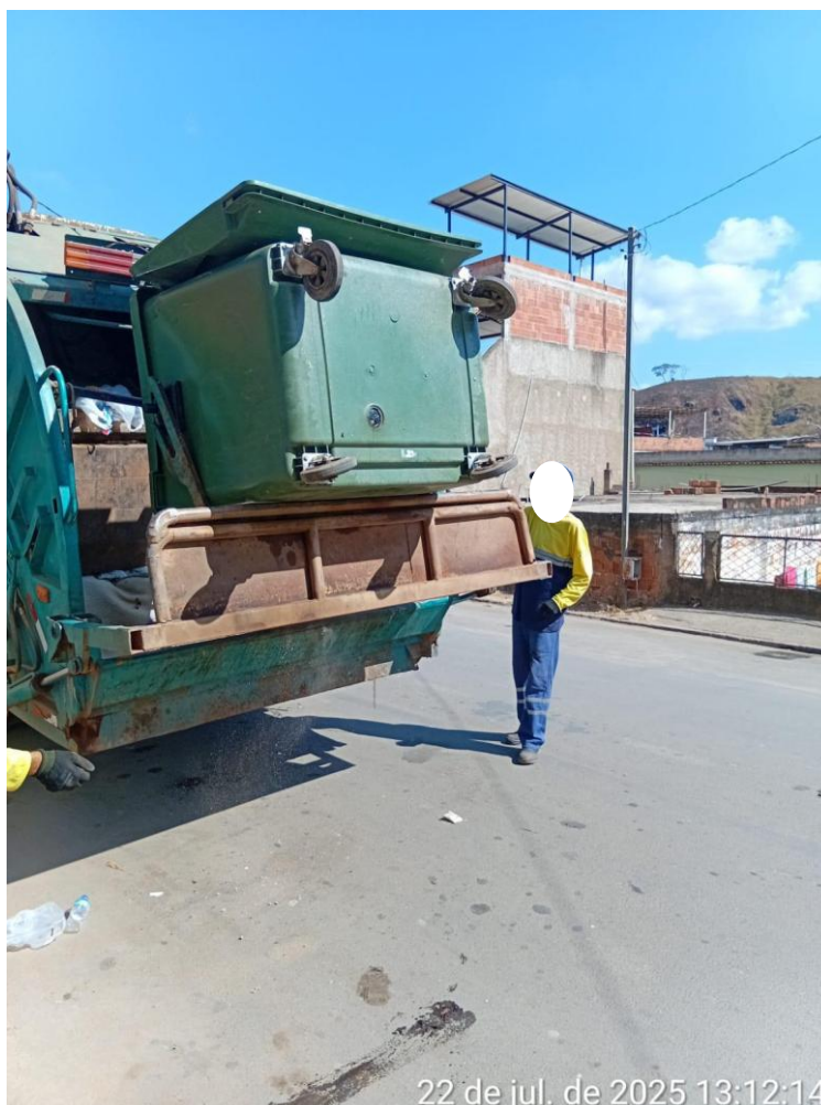
Coleta com elevação de contêiner pelo caminhão compactador terceirizado.
