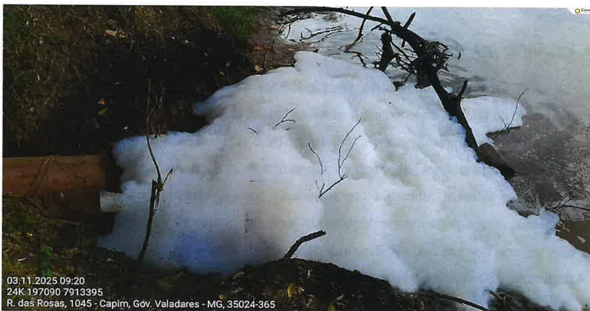
Foto 01: Fenômeno da saponificação presente nos efluentes tratados da ETA Santos Dumont, lançados no Rio Doce.
